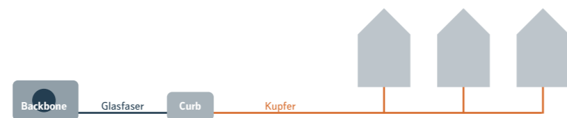
Fiber to the Curb (FTTC): Glasfaser bis zum Verteiler
