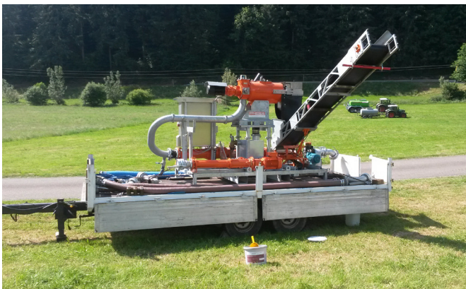
Foto 9: Gülleseparierer für den mobilen Einsatz
