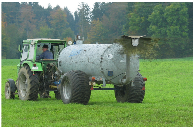
Foto 3: Prallkopfverteiler (ab 2025 nicht mehr zulässig)
